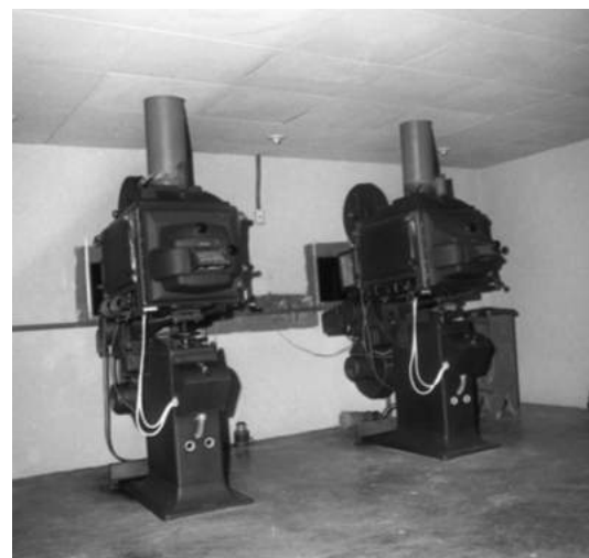
Cabina de proyección del Teatro San Carlos con sus dos proyectores de bobinas, con iluminación por sistema de carboncillo que es el estándar de la época. Fuente: Fondo Editora Hoy/AGN.
